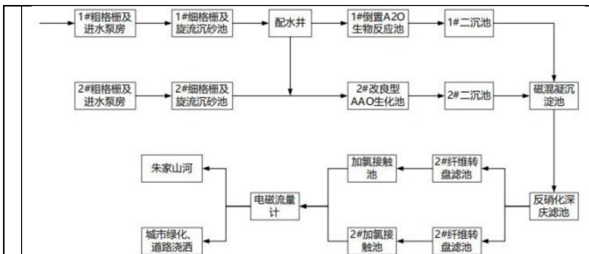
图 4-2 污水处理厂处理工艺流程图
