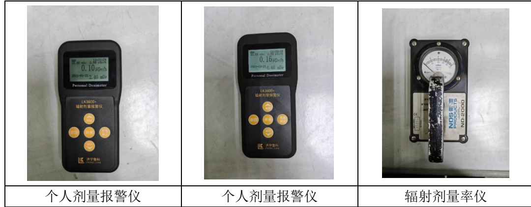
图 3-2 本项目辐射监测仪器
